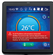
Affichage de l'alarme, diagnostic et solution de résolution
